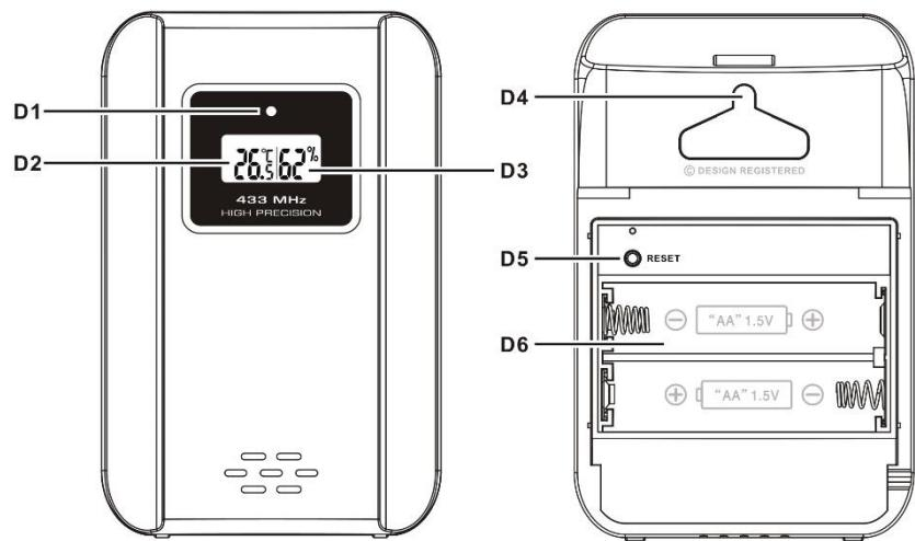
D1: LED-Anzeiger der Signalübertragung
