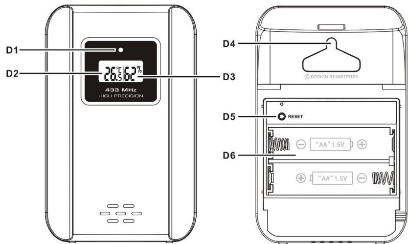
D1: Dioda LED transmisji sygnału
